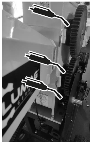
Schmierstellen unterhalb der Abdeckung
