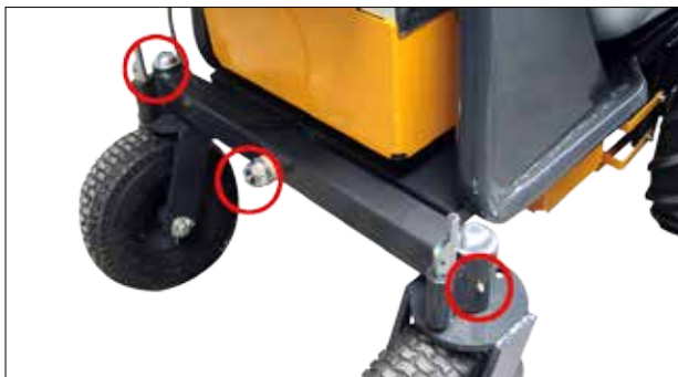
Die Drehpunkte der Pendelachse alle 80 Betriebsstunden nachschmieren.
